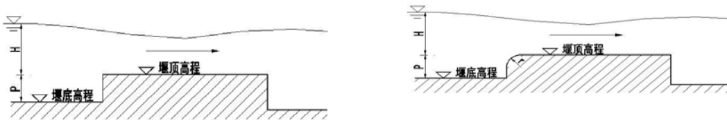
图 5.3-1 直角和修圆进口的有底坎宽顶堰
