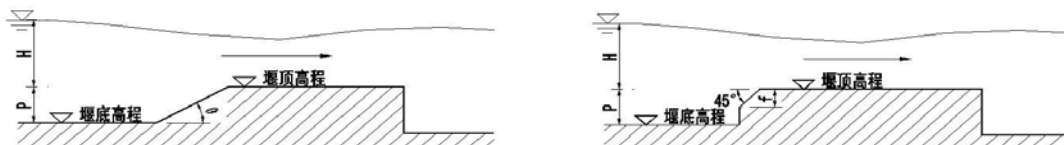
图 5.3-2 斜坡和斜角式进口的有底坎宽顶堰
