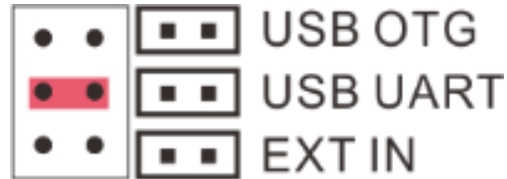
图 3 供电输入口和跳线帽跳线方式的对应关系图
