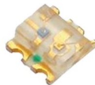
图 9 三色 LED 及其连接示意图
