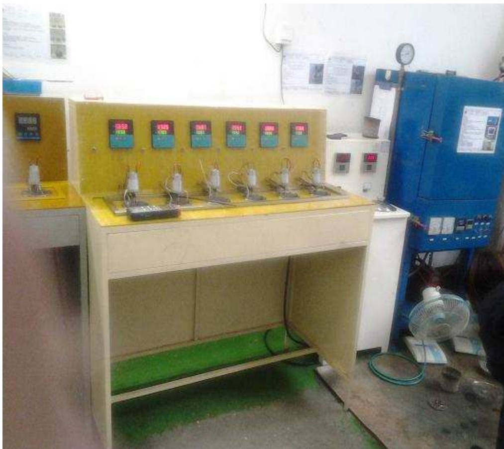
双金属片测试油槽
